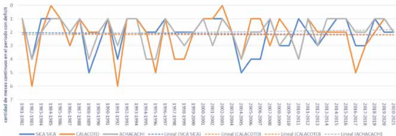
FIGURA 31. Continuidad de condiciones deficitarias con umbral al de -0.5 de SPEI
